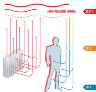
**Cos'è la convezione:** Il riscaldamento di tipo convettivo scalda prevalentemente l'aria ambiente che stratifica sul soffitto e comunque poi deve essere ovviamente cambiata con l'esterno causando una perdita di energia
