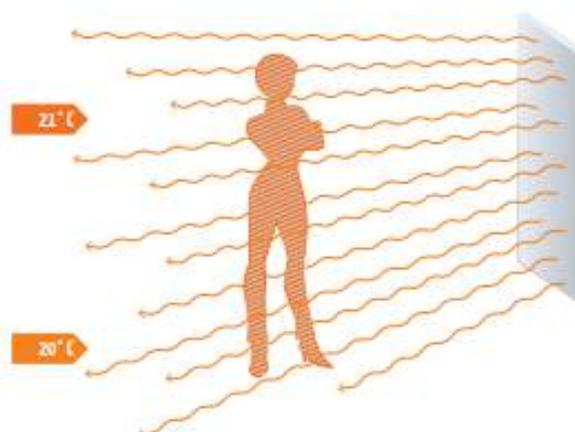
Limitano la stratificazione termica a 0,5°C per ogni metro d'altezza del locale; ciò significa che su locali alti 3 mt si avrà una differenza massima tra pavimento e soffitto di 1,5°C contro i circa 4,5°C dei normali caloriferi convettivi. Quindi se siamo noi ad avere freddo perché scaldare il soffitto? E perché riscaldare l'aria quando siamo noi ad aver necessità di comfort?
